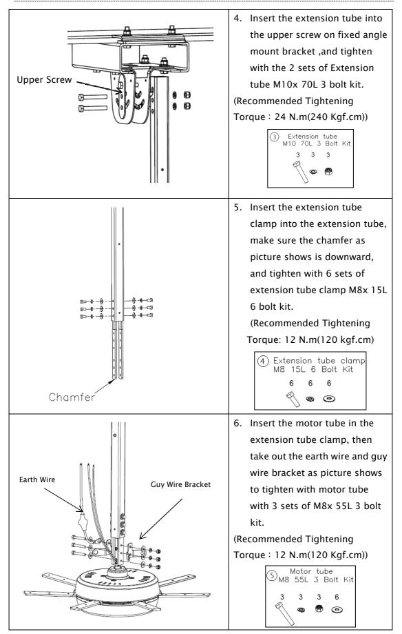
17 SUNONWEALTH ELECTRIC MACHINE INDUSTRY CO., LTD. UFO 3 INSTALLATION (2019.12.23) V1
